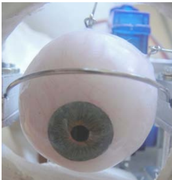
Figura 5.4: Detalhe das argolas de acionamento dos olhos
