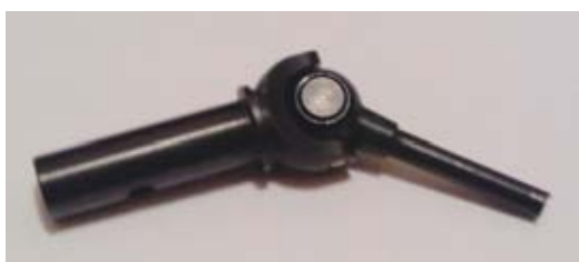
Figura 4.5: Junta universal utilizada no mecanismo
